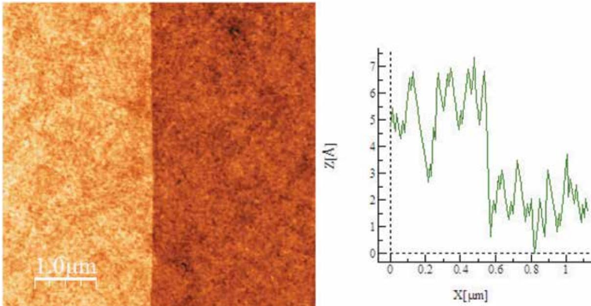
Fig. 18. Step height  $\sim 0.3$  nm (1 layer).
